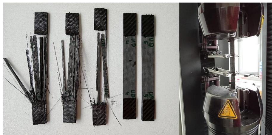
Zugversuche eines UD-Laminats
