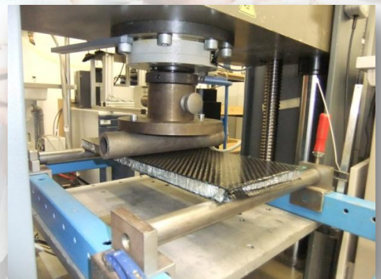
Monocoque Probekörper 3-Punkt-Biegeversuch
