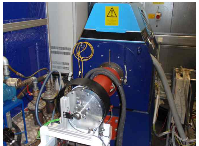
Dynamischer Motorprüfstand mit ZRM1-V
