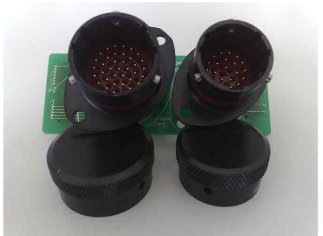
Motorsportstecker zur Anbindung des Kabelbaums an die Elektronik
