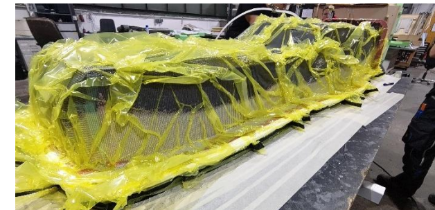
Temperung der Monocoque-Negativform bei der Protomaster GmbH .
