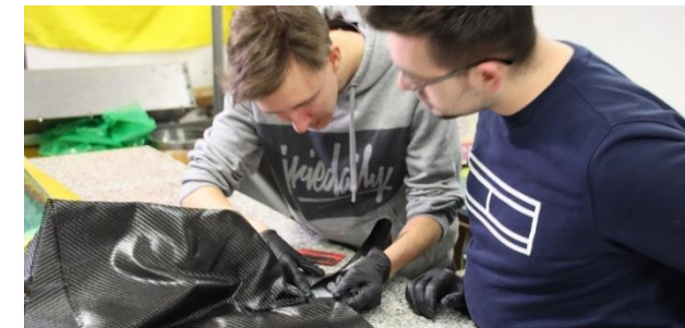
Die Laminierung des Lenkrads.
