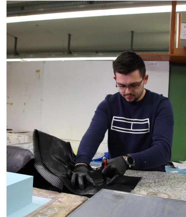
Die Laminierung des Lenkrads.
