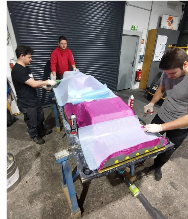
Temperung der Monocoque-Negativform bei der Protomaster GmbH .
