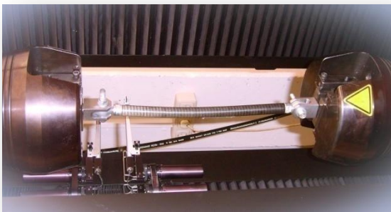
Querlenkerrohr im Kickversuch
