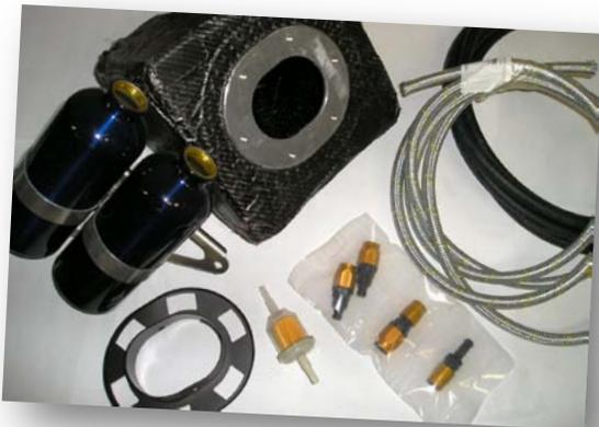
Letzte Woche wurde die Positivform für unseren Tank aus Styropor zugeschnitten. Da die Tankinsert bereits vorhanden waren, konnten wir ihn auch gleich laminieren. Ebenso hat uns eine langersehnte Bestellung diverser Tankteile erreicht. Zusammen mit diesen Teilen und der montierten Pumpeneinheit kann unser Tanksystem komplettiert und nach einer Dichtheitsprüfung in den FP410 eingebaut werden.
