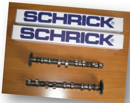
Dieses Jahr stehen uns Nockenwellen mit einer geänderten Öffnungsfunktion zur Verfügung, die die Firma AVL Schricker aus Remscheid auf unsere Bedürfnisse angepasst und geschliffen hat. Das Prototypenzentrum aus Dresden fertigte uns eine Laminierform für die Airbox. So kann eine saubere Luftführung im Ansaugtrakt bei gleichzeitig niedrigem Gewicht gewährleistet werden.
